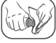
Aplikátor očistěte bavlněným hadříkem nebo savým papírem tak, aby byl na pohled suchý a čistý.
